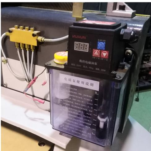
Tanto los patines como el husillo se lubrican automáticamente mediante una bomba temporizada para dosificar el lubricante necesario a cada parte móvil. Esta temporización puede ser programada por el cliente tanto en cantidad como en frecuencia de lubricación, para ajustarse a las necesidades del tipo de trabajos de cada cliente.
