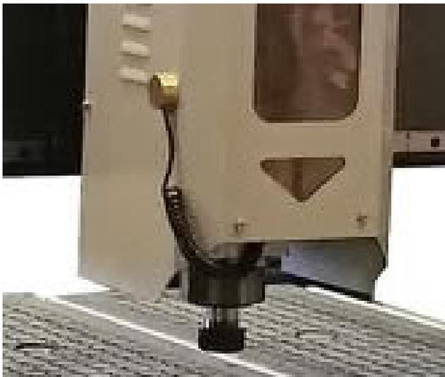
Las fresadoras de la serie ECO en su versión de cambio manual de herramienta, dispone en el mismo cabezal de una sonda con base magnética, para la toma de altura de la herramienta.
