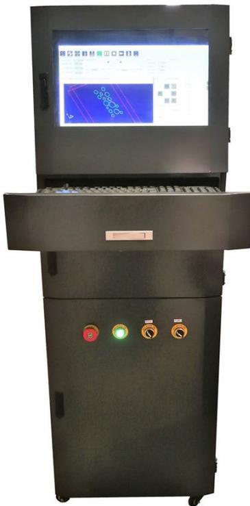
La fresadora está equipada con una consola para puesto de trabajo, disponiendo de ruedas para una fácil colocación y acomodo para el puesto de trabajo del operario de la máquina. El cuadro de maniobras y potencia está ubicado en la misma consola, disponiendo de puertas para un fácil acceso a su interior para mantenimiento.
