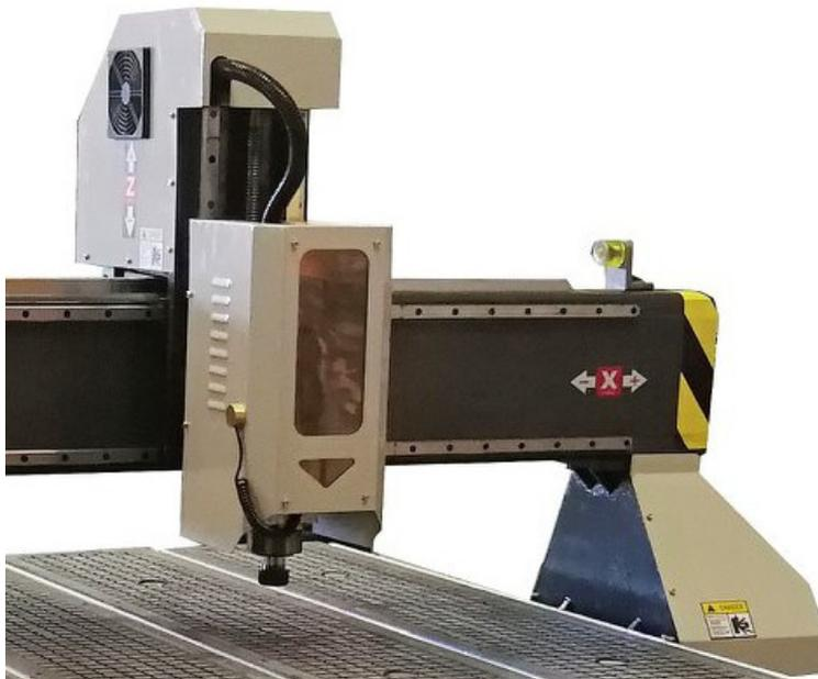
El pórtico está sustentado sobre laterales construidos en fundición de acero, lo que le confiere una gran rigidez y suprimiendo posibles vibraciones durante el mecanizado.
