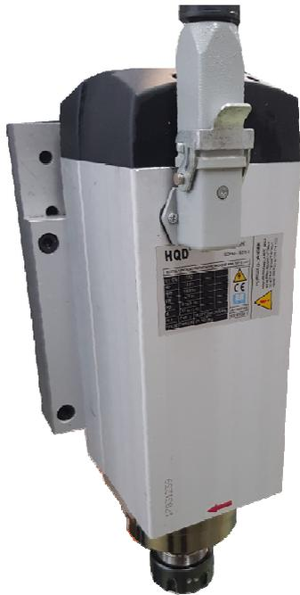
Las fresadoras de la serie ECO- 1 V Se equipan con un motor fresador de 3,5kW de alta frecuencia, pudiendo alcanzar las 18.000 RPM.
