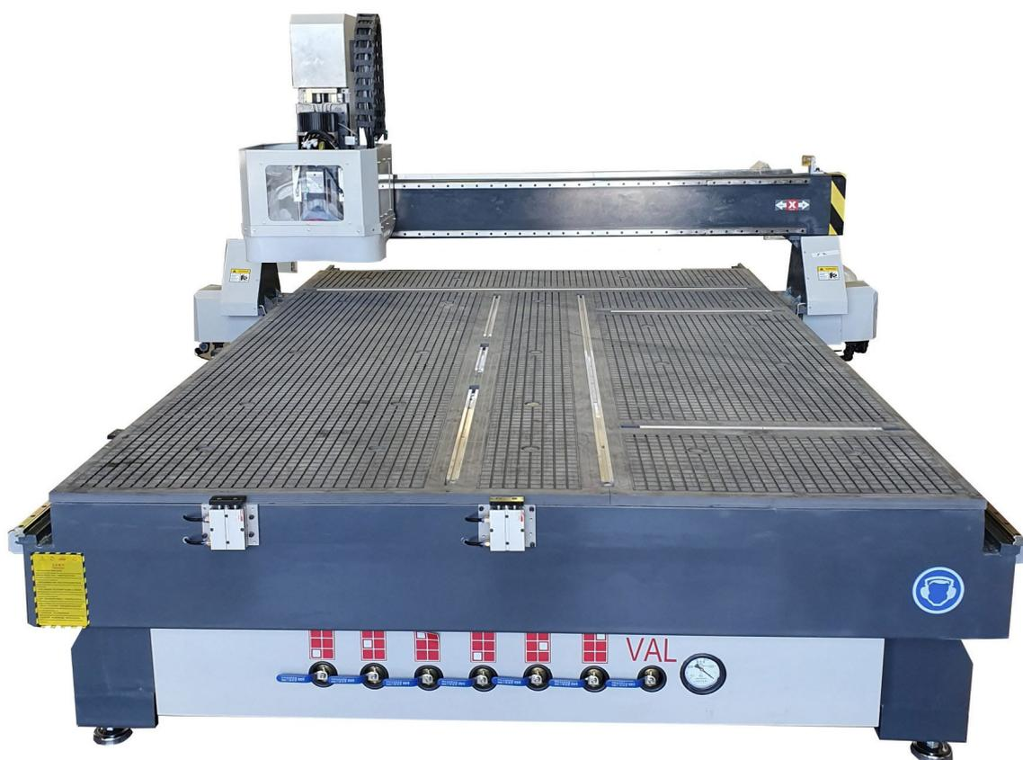
Chasis construido en tubo de acero rectangular de gran espesor, soldado en su totalidad confiriendo una gran resistencia estructural.
